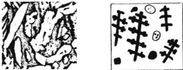
Рисунок 9.4. Микроструктура литой бронзы (слева), \times 200 , справа – схема зарисовки
