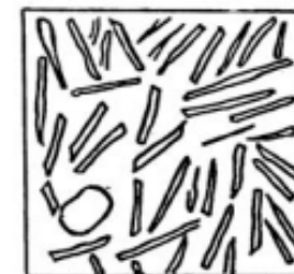
Рисунок 9.7. Микроструктура немодифицированного силумина АК12: кристаллы избыточного кремния и игольчатая эвтектика \alpha + \text{Si} (слева), \times 200 , справа – схема зарисовки
