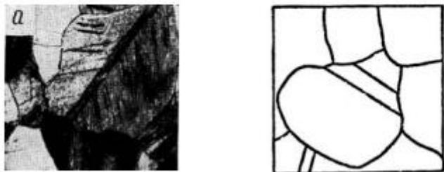
Рисунок 9.2. Микроструктура деформированной и отожженной однофазной латуни Л80 (слева), \times 200 , справа – схема зарисовки
