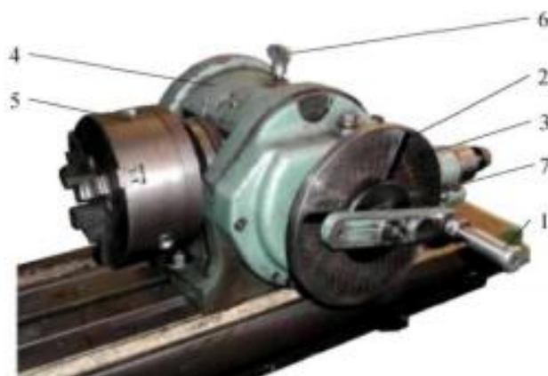
Рисунок 3- Универсальная делительная головка; 1 рукоятка с фиксатором; 2 раздвижной сектор; 3 делительный диск (лимб); 4 корпус; 5 шпиндель с патроном; 6 фиксатор шпинделя; 7 фиксатор лимба
