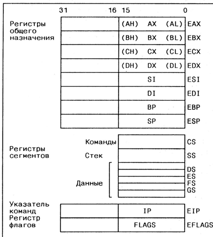
Рис. 4.89. Основные функциональные регистры микропроцессора i486
