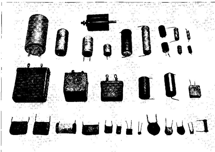
Рис. 6.2. Внешний вид наиболее распространенных типов конденсаторов
