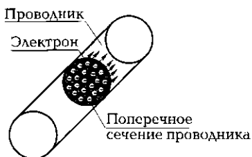
Рис. 1.3. Электроны, проходящие через поперечное сечение проводника
