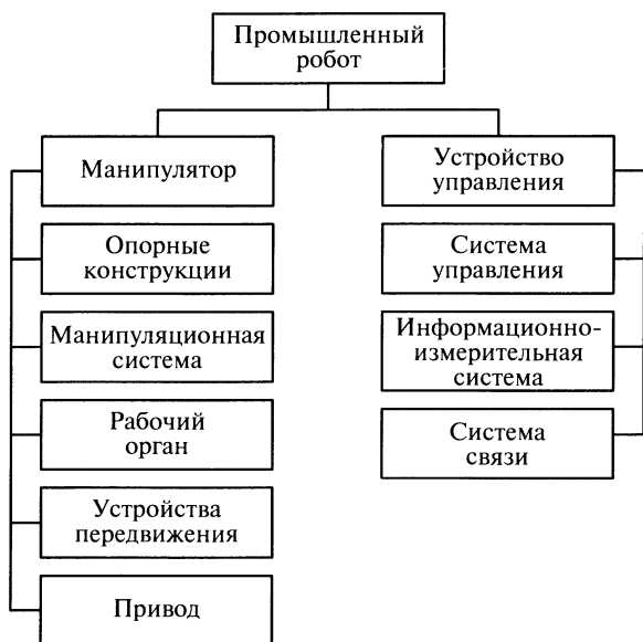
Рис. 11.2. Структурная схема промышленного робота
