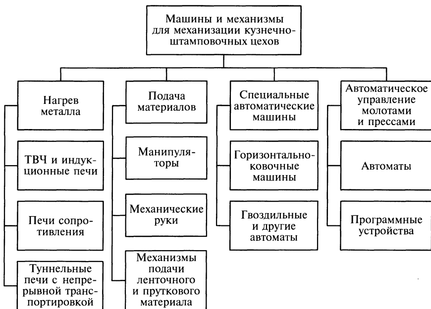
Рис. 7.5. Классификация машин и механизмов для механизации кузнечно-штамповочных цехов
