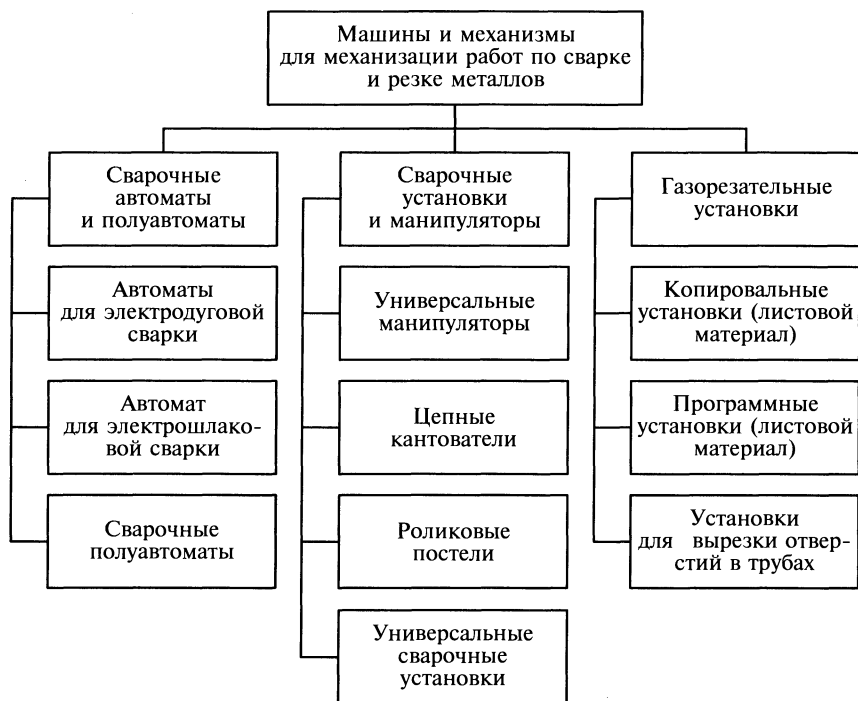
Рис. 7.9. Схема классификации машин и механизмов для механизации работ по сварке и резке металлов
