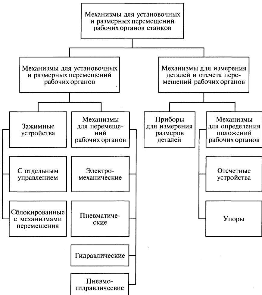
Рис. 8.2. Классификация механизмов для установочных и размерных перемещений рабочих органов станков
