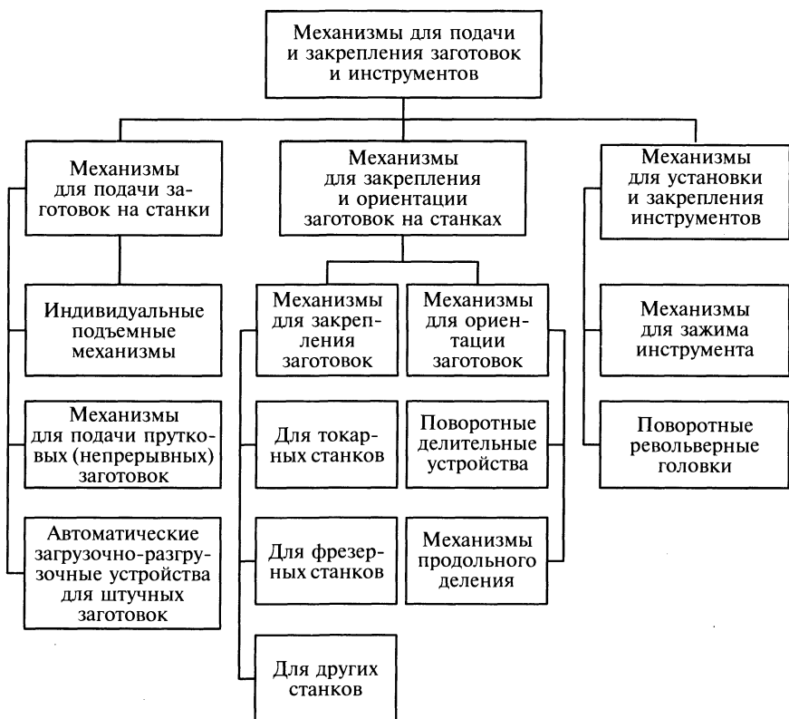
Рис. 8.1. Классификация механизмов для подачи и закрепления заготовок и инструмента
