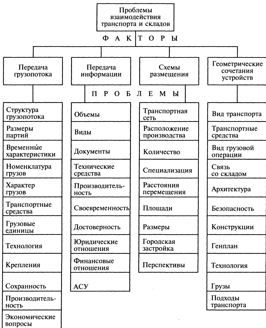
Рис. 15.2. Классификация компонентов взаимодействия транспорта и складов промышленных предприятий на основе профакторного анализа
