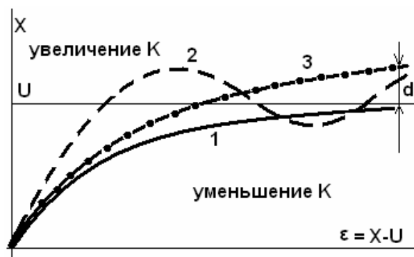
Рисунок 6.7 – Процесс регулирования П – регулятором при скачкообразном изменении задания с 0 до U (разгонная кривая).
