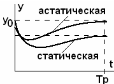
Рисунок 3.11 – Динамика статических и астатических САР после возмущения.
