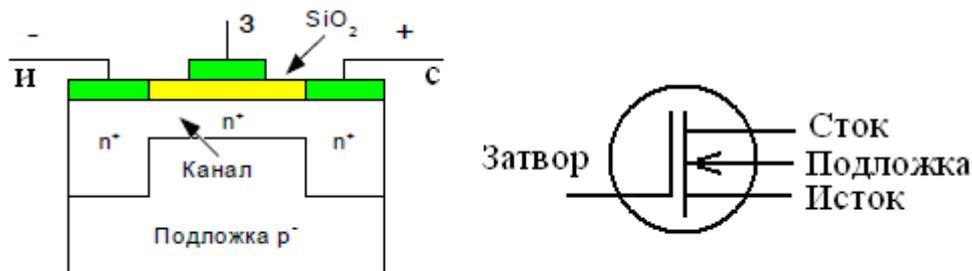
Схема МОП-транзистора с встроенным каналом
