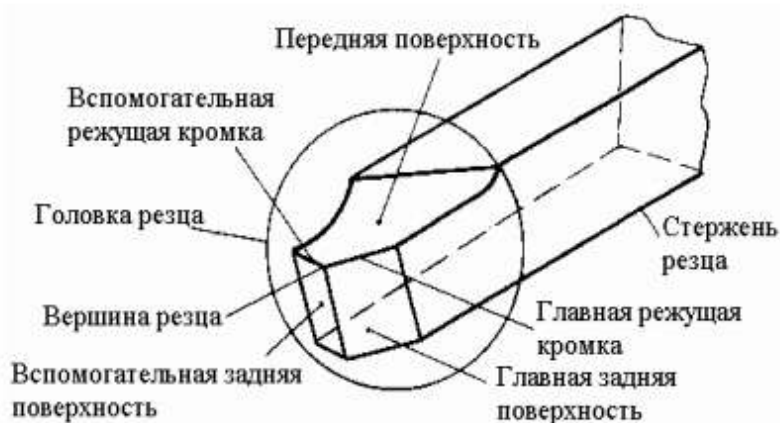
Рис. 5.3. Элементы токарного резца
