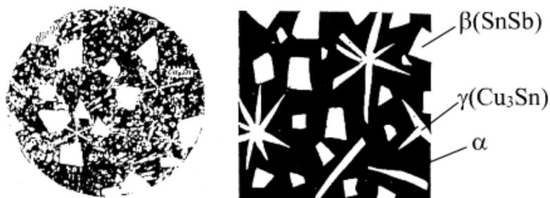
Рис. 15.1. Микроструктура баббита Б83
