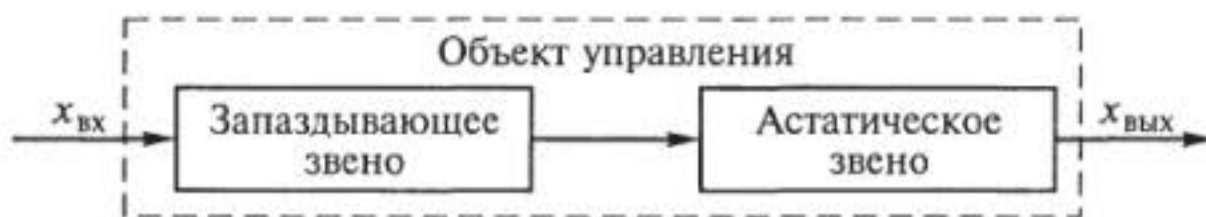
Рис. 10.9. Схема цепи звеньев, полученной при аппроксимации сложного астатического объекта с запаздыванием
