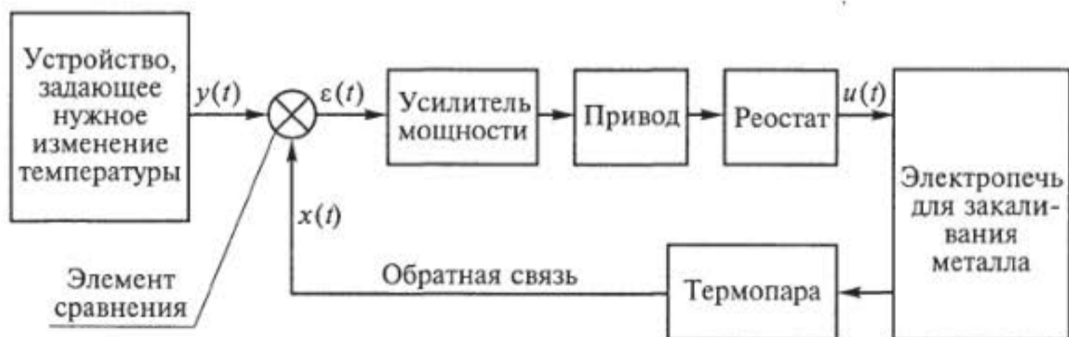
Рис. 1.4. Функциональная схема автоматической системы, реализующей процесс закаливания металла в электропечи
