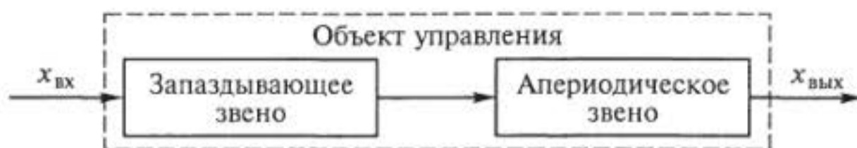
Рис. 10.7. Схема цепи звеньев, полученной при аппроксимации сложного статического объекта с запаздыванием
