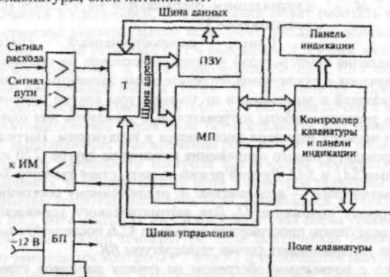
Рис. 1.17.2. Функциональная схема микропроцессорного контроллера САУ: Т — программируемый таймер; ПЗУ — постоянное запоминающее устройство; МП — микропроцессор; БП — блок питания
