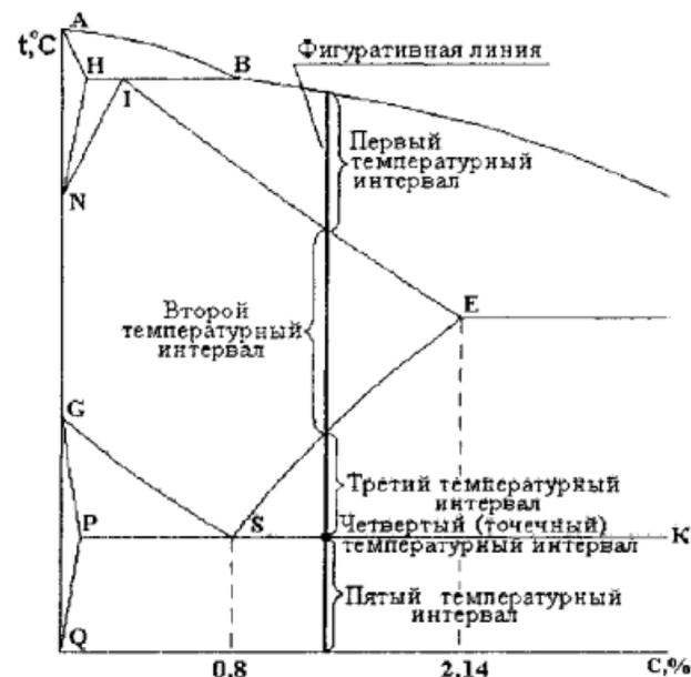
Рисунок 5.1-Фрагмент диаграммы состояния Fe - C для определения количества температурных интервалов
