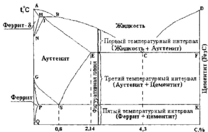
Рисунок 5.2 - Фрагмент диаграммы состояния Fe - C для определения фазового состава двухфазных областей
