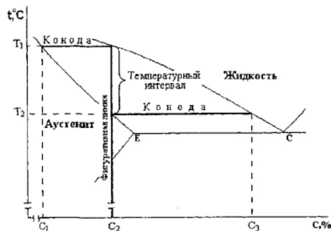
Рисунок 5.3 - Фрагмент диаграммы состояния Fe - C для определения концентрации углерода в фазах в двухфазных областях
