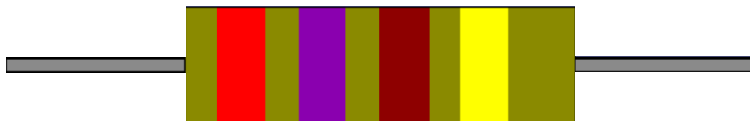
Рис. 2. Определение сопротивления резистора и производственного допуска
