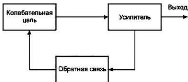
Рис. 2 Структурная схема электронного генератора
