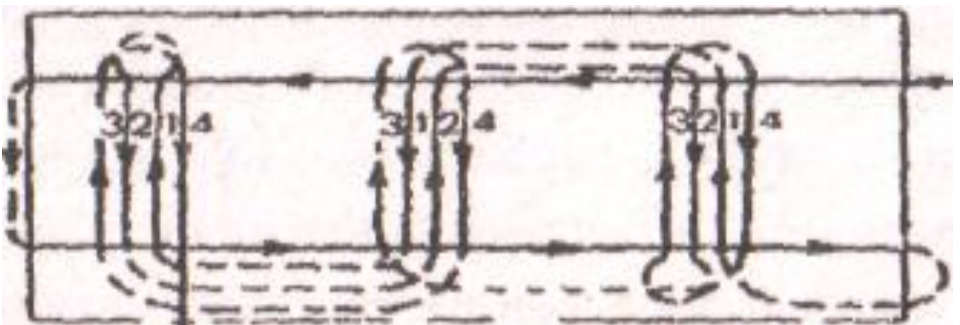
Рисунок 7.1 – Схема движения агрегатов при разбивке загонов для вспашки: a – с чередованием загонов; б, в – с формированием свальных гребней в три и четыре прохода; 1 – проходы агрегата, E – ширина поворотной полосы; B – ширина загона.
