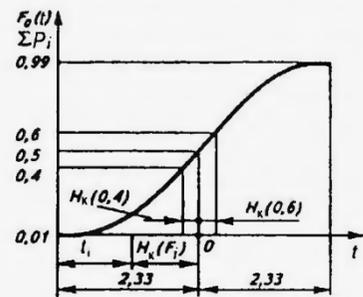
Рис.4.8. Схема определения координаты  $y_i$  при законе нормального распределения
