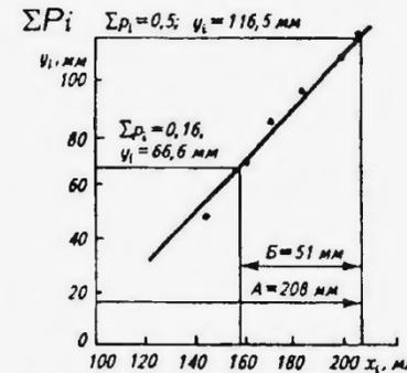
Рис.4.10. Графическая часть обработки усеченной информации по закону нормального распределения
