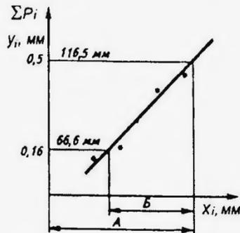
Рис.4.9. Схема определения  $\bar{t}$  и  $\sigma$  по интегральной прямой отказности закона нормального распределения
