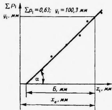
Рис.4.11. Схема определения параметров  $a$  и  $b$  закона Вейбулла
