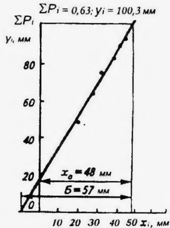
Рис.4.12. Графическая часть обработки усеченной информации по закону распределения Вейбулла
