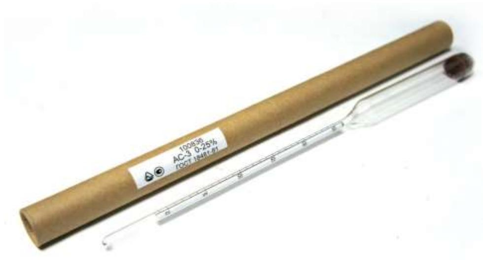
Рис. 3. Ареометр
