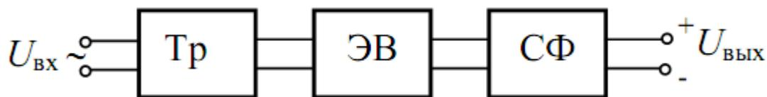
Рис. 1. Структура выпрямительного устройства
