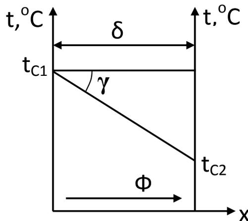
Рис.2. Распределение температуры в плоской стенке при  $\Phi=const$ .
