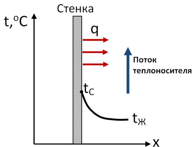
Рис. 3. Процесс теплоотдачи
