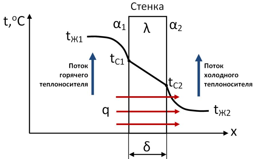
Рис. 4 Теплопередача через плоскую однослоиную стенку
