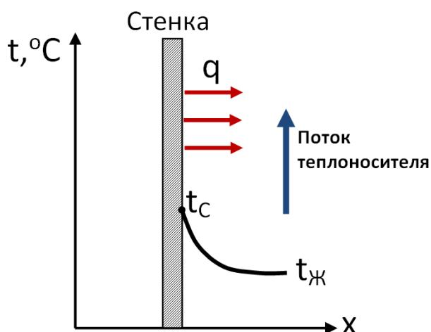
Рис. 3. Процесс теплоотдачи
