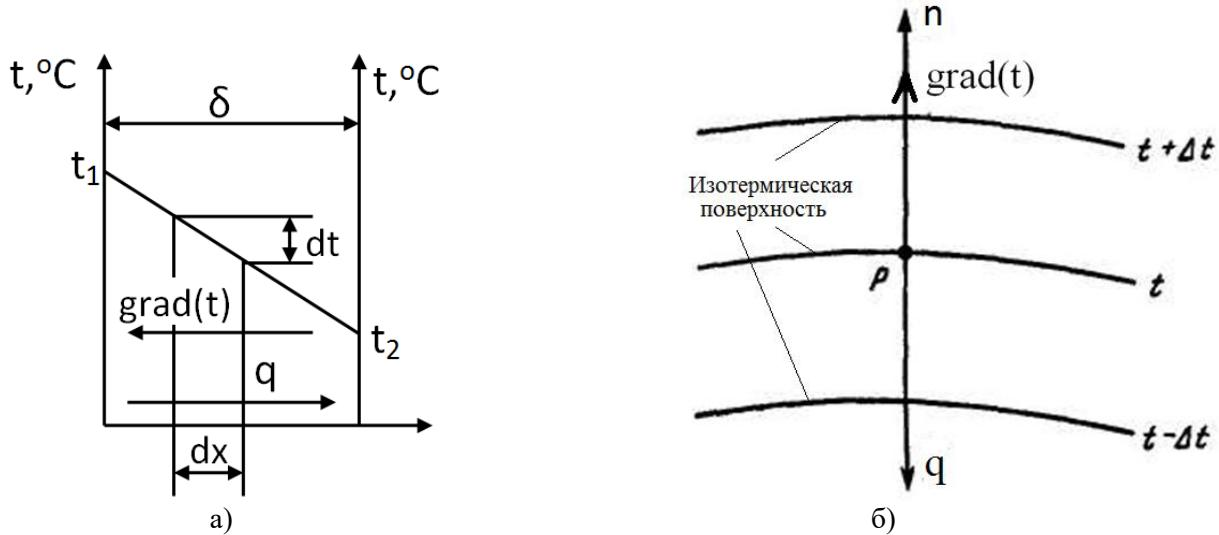
Рис. 1. К формулировке основного закона теплопроводности Фурье.
