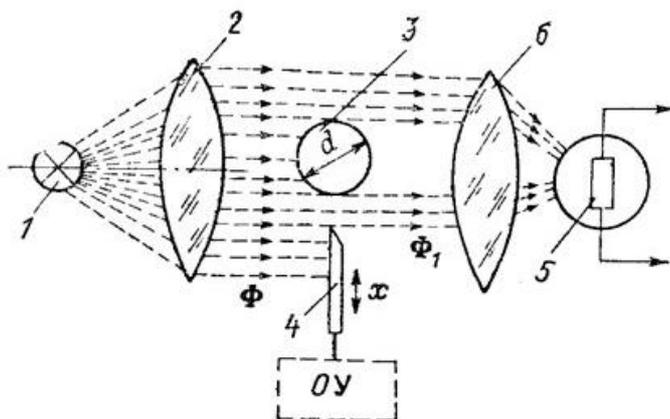
Рис. 6. Фотодатчик со световым потоком, прерываемым ОУ
