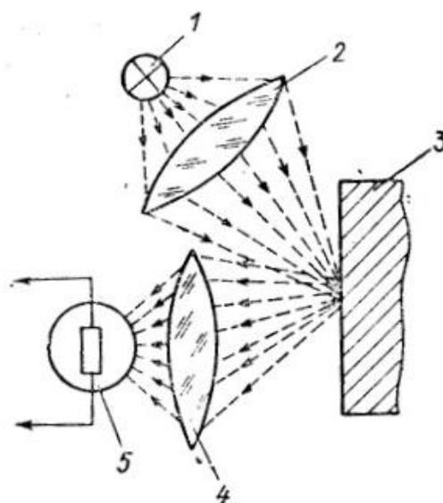
Рис. 7. Фотодатчик со световым потоком, отраженным от ОУ
