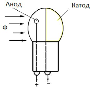
Рис. 10. Фотоэлемент с внешним фотоэффектом
