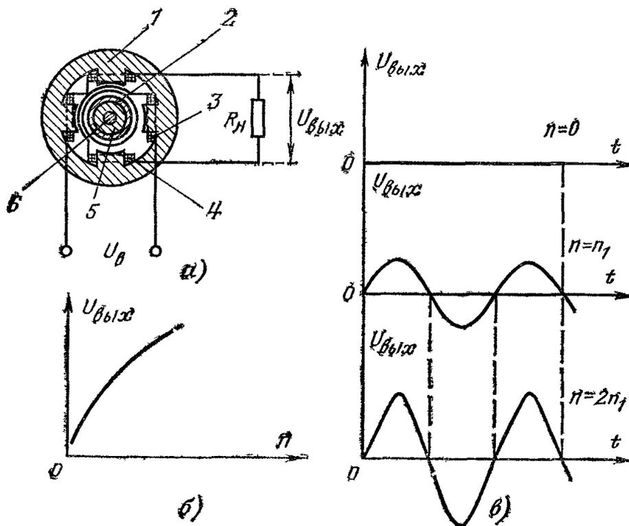
Рис. 5. Асинхронный тахогенератор: а) конструкция б) статическая характеристика; в) к пояснению того, что частота вых. напряжения не изменяется от частоты вращения ротора
