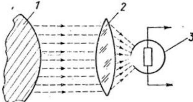
Рис. 8. Фотодатчик со световым потоком, излучаемым ОУ
