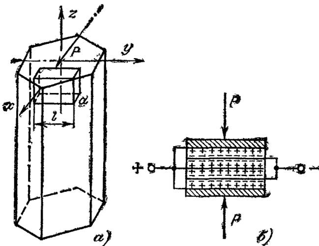
Рис. 2 Пьезоэлектрический датчик:
