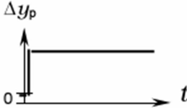
Рис. 4 Кривая разгона П-регулятора
