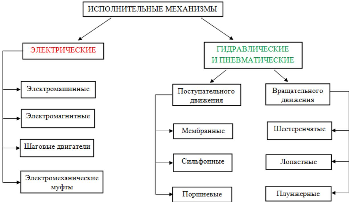
Рис. 2. Классификация исполнительных механизмов
